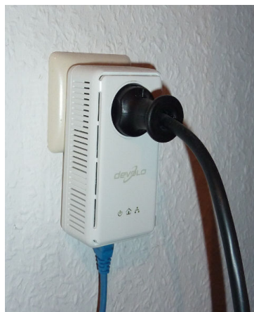
Abbildung 6.3: Reduziert die Strahlenbelastung durch WLAN und versorgt PCs im ganzen Haus: der PowerLAN-Adapter
