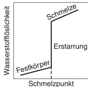
Abbildung 5.33: Löslichkeit von Wasserstoff in Aluminium. Bei der Erstarrung des Aluminiums nimmt dessen Löslichkeit für Wasserstoff drastisch ab.
