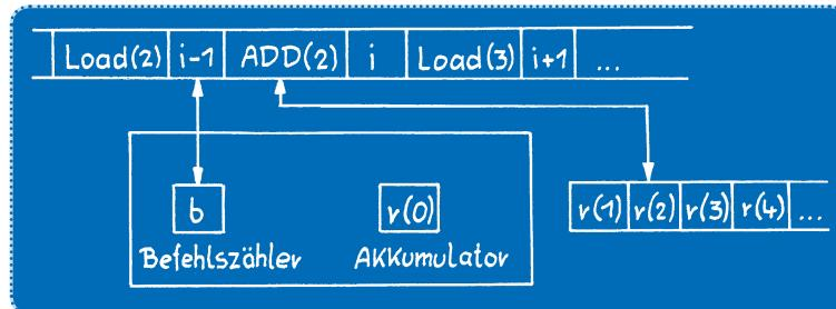
Die einzelnen Zeilen des Programms sind durchnummieriert. Um sich zu merken, welche Befehlszeile als Nächstes bearbeitet werden muss, gibt es einen Befehlszähler. Die Daten können aus den Registern in den Akkumulator geladen und dort durch die Befehle bearbeitet werden.
